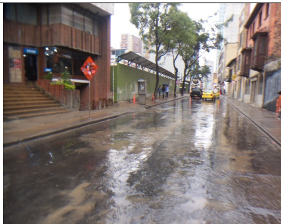
Fotos 18, 19 y 20. Se observó la salida de agua disuelta con sedimentos al espacio público. Así mismo se evidenció la conducción del agua disuelta con sedimentos afectando el sistema de drenaje interno del Edificio Santa Margarita colindante con el predio en construcción.
