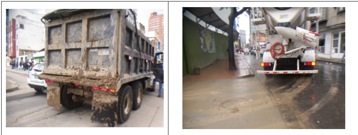
Foto 12 y 13. No se ejerce control riguroso a la limpieza adecuada de los vehículos relacionados con el proceso constructivo previa evacuación del predio.
